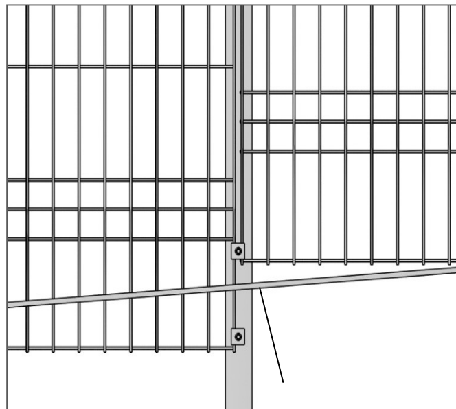
Рис. № 3 и 4. Схема крепления панелей и КЗ для перепада высоты менее 200 мм
